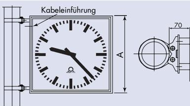
Uhr zweiseitig mit seitlicher Mastbefestigung „SM“
